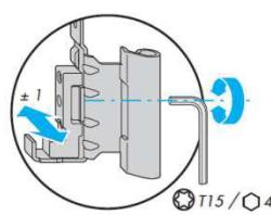
Seřízení přítlaku imbusovým klíčem č. 4
