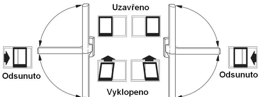
V případě dvoukřídlých dveří je ovládací klika umístěna na obou křídlech. Pro plné otevření je nutno otevřít nejdříve hlavní křídlo a poté vedlejší křídlo.
