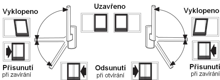
U sklopně posuvných oken se spřaženou klikou je možno při poloze klinky „vyklopeno“ křídlo sklopit. Posunem klinky do polohy „odsunutí při otvírání“ se křídlo odstaví z rámu a poté je možno křídlo odsunout do strany. Při zavírání křídla s polohou klinky „Přisunutí při zavírání“ dojde při jeho přisunutí k zacvaknutí do kování a poté otáčením klinky do polohy zavřeno se křídlo přitlačí do rámu a uzavře se.
