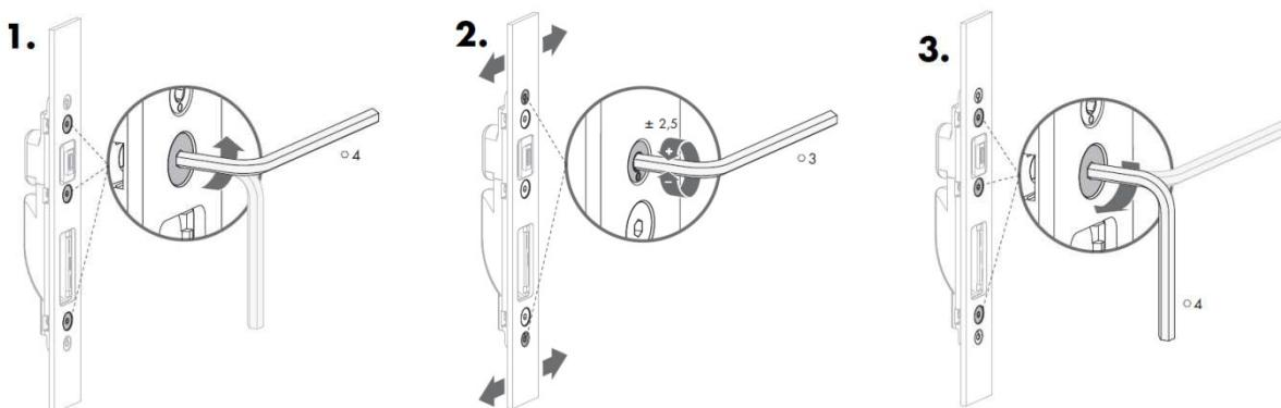
Povolit zajišťovací šrouby imbusovým klíčem 4mm
