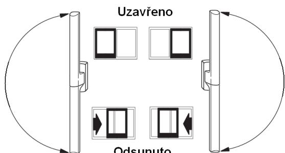
Dvoukřídlé provedení se srazem křídel – u dvoukřídlého provedení je jedno křídlo hlavní a jedno vedlejší. Pro otevření obou křídel je nutné otevřít nejdříve hlavní křídlo. Při zavírání postupujeme opačně.
