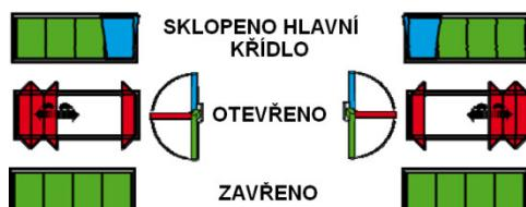
**!** Při skládání je nutno si dát pozor na poškození křídel od kliček.
