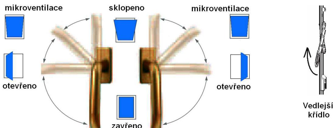
V případě dvoukřídlých oken není vedlejší křídlo osazeno ovládací kličkou, ale páčkou ukrytou ve funkční spáře okna. Pro otevření tohoto křídla je nutné nejdříve otevřít hlavní křídlo, a poté otočením páčky uvolnit uzavírací body.
